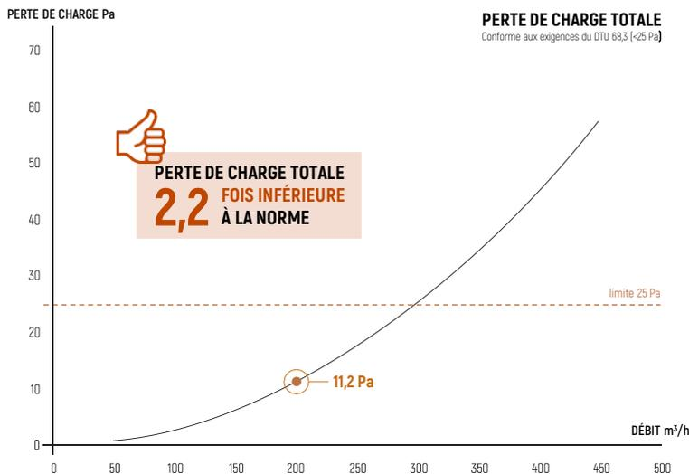
résultats d'essais réalisés et contrôlés par le selon la norme NF EN 13141-5 : 2020
